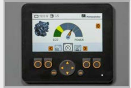
La gestion de performance (en option) permet d'ajuster la puissance du moteur selon les besoins. Il est possible d'économiser du carburant ou d'obtenir de l'énergie supplémentaire.
