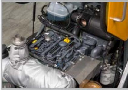
Plus de puissance d'entraînement grâce au moteur Deutz de 36,4 kW – et de plus il répond à toutes les exigences de la norme d'émission Stage V en vigueur.
